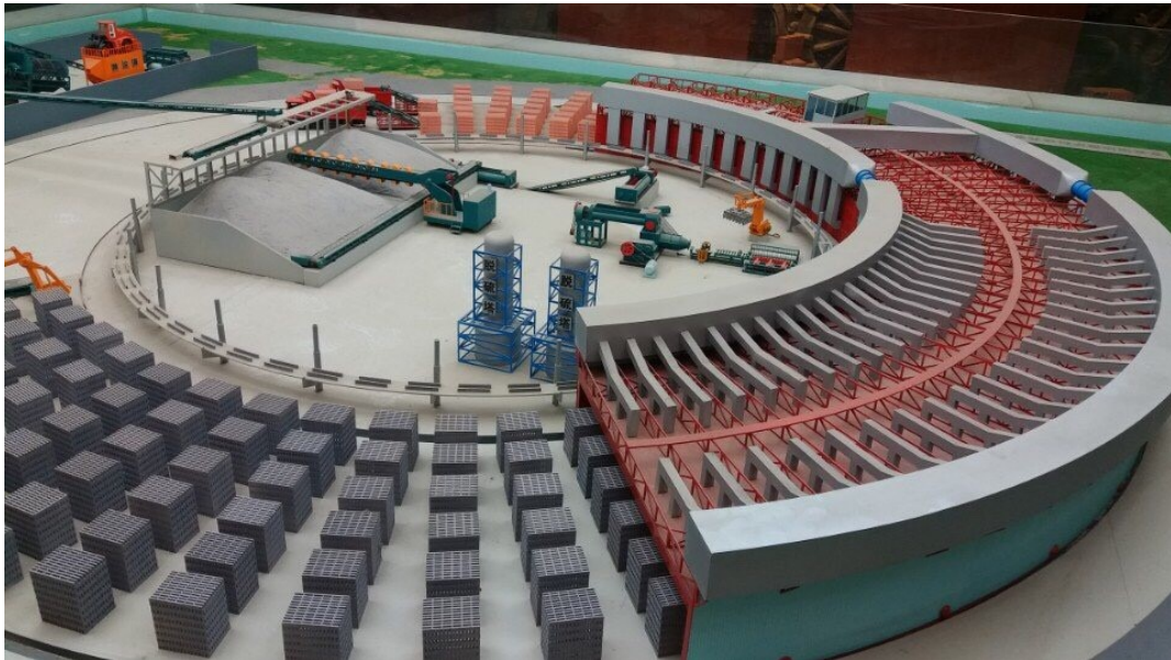
Hình 7.4 Sơ đồ nguyên lý lò nung tuynen di động
